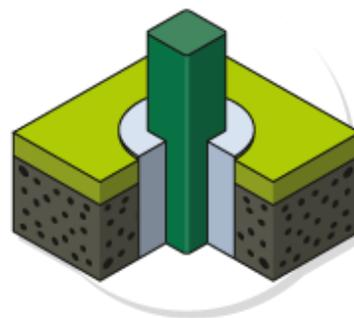
Использование опорных столбов, заглубленных в почву, обеспечивает высокую стабильность металлоконструкций даже в районах со слабым и подвижным грунтом.
