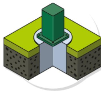
Секции прикручиваются к столбам, столбы устанавливаются на фланцы и закрепляются анкерными болтами.
